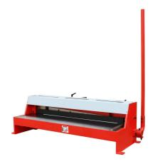
Die Holzmann TBS1050PRO Präzisions-Tafelblechschere ist ideal für die Bearbeitung von Blechen. Sie verfügt über eine manuelle Hinteranschlag mit Skala, einen Winkelanschlag vorne, ein verchromtes Hartstahlmesser, eine Schnittlinienbeleuchtung, eine Zweiarmbedienung und eine automatische Niederhaltung, zur Fixierung des Bleches.
