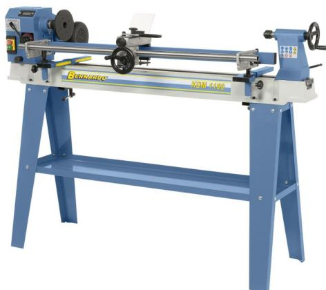
Die Drechselmaschine KDM 1100 ist serienmäßig mit einer Kopiereinrichtung sowie einem umfangreichen Standardzubehör ausgestattet. Durch die stabile Gussausführung und dem fairen Preis-Leistungsverhältnis ist diese Maschine ideal für den Einsteiger.
