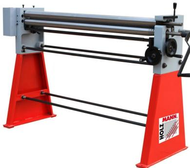
Die Holzmann RBM1250M manuelle Rundbiegemaschine bietet ein komfortables Exzenterspannungs- und einfache Bedienung. Die stabile und schwere Gusseisenkonstruktion sowie die hochwertigen Walzen aus Hochdruckstahl garantieren eine hohe Lebensdauer. Die Maschine verfügt über ein asymmetrisches 3-Walzensystem und eine Oberwalze, die ausschwenkbar mit Exzenterverschluss ist.
