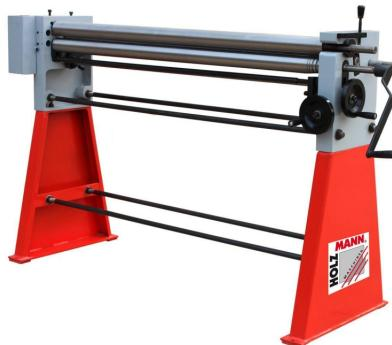
Die Holzmann RBM1250M manuelle Rundbiegemaschine bietet ein komfortables Exzenterspannungs- und einfache Bedienung. Die stabile und schwere Gusseisenkonstruktion sowie die hochwertigen Walzen aus Hochdruckstahl garantieren eine hohe Lebensdauer. Die Maschine verfügt über ein asymmetrisches 3-Walzensystem und eine Oberwalze, die ausschwenkbar mit Exzenterverschluss ist.
