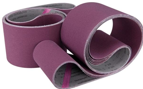
Das Bernardo Gewebeschleifband 1180 x 75 mm - K 120 ist ein universell einsetzbares Schleifband aus Elektrokorund zum Schleifen und Entgraten von Stahlblech, Aluminium, Gussteilen, NE-Materialien, Sperrholz, Weich- und Harthölzern. Es bietet hohe Wirtschaftlichkeit auf Grund hoher Standzeit und Leistung.
