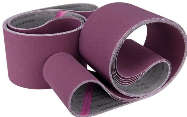
Das Bernardo Gewebeschleifband 1180 x 75 mm - K 60 ist ein universell einsetzbares Schleifband aus Elektrokorund. Es eignet sich zum Schleifen und Entgraten von Stahlblech, Aluminium, Gussteilen, NE-Materialien, Sperrholz, Weich- und Harthölzern. Das Schleifband bietet eine hohe Wirtschaftlichkeit auf Grund hoher Standzeit und Leistung.
