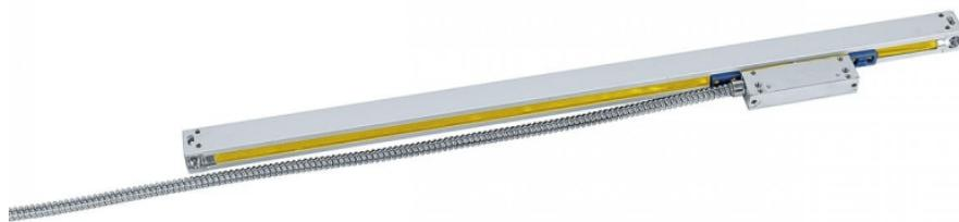
Die linearen Wegmesssysteme der Serie GS sind präzise Messsysteme für lineare Bewegungen. Die mechanische Konstruktion der Abtasteinheit ist mit Miniatatkugellagern mit selbstständiger Führung ausgeführt, welche die Unebenheiten der Maschinenführung infolge von ungenauer Montage bzw. Abnutzung ausgleicht.
