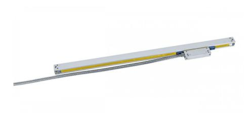
Die linearen Wegmesssysteme der Serie GS sind präzise Messsysteme für lineare Bewegungen. Die mechanische Konstruktion der Abtasteinheit ist mit Miniaturkugellagern mit selbstständiger Führung ausgeführt, welche die Unebenheiten der Maschinenführung infolge von ungenauer Montage bzw. Abnutzung ausgleicht.
