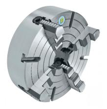
Die Bernardo Planscheibe K72-500/D8" Planscheiben ist eine hochwertige Planscheibe für verschiedene Anwendungen. Die Planscheibe hat eine Futtergröße von 500/D8, einen Durchmesser von 500 mm und einen Kegel von 8. Die maximal mögliche D1 beträgt 139,72 mm, die D2 171,4 mm und die D3 125 mm. Die Höhe H1 beträgt 106 mm. Die maximale Drehzahl liegt bei 400/min. Das Gewicht der Planscheibe beträgt ca. 95 kg.
