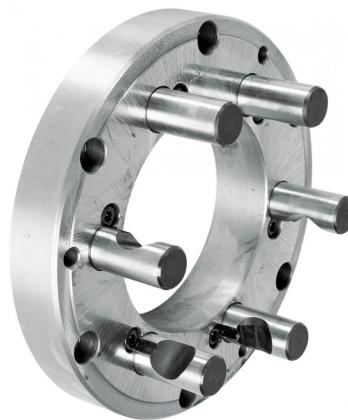
Der Bernardo Kurzkegelflansch FLD-630/D11 ist ein Kurzkegelflansch in Gussausführung. Er ist maschinenseitig fertig bearbeitet und futterseitig vorgedreht und gebohrt. Der Flansch ist für die Befestigung von Planspiral-Drehfutter und Planscheiben mit zylindrischer Aufnahme geeignet.
