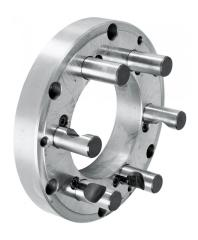
Der Bernardo Kurzkegelflansch FLD-500/D15 ist ein Kurzkegelflansch in Gussausführung. Er ist maschinenseitig fertig bearbeitet, futterseitig vorgedreht und gebohrt. Der Flansch ist für die Befestigung von Planspiral-Drehfutter und Planscheiben mit zylindrischer Aufnahme geeignet.
