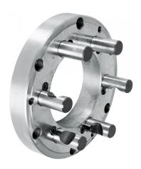
Der Bernardo Kurzkegelflansch FLD-500/D11 ist ein Kurzkegelflansch in Gussausführung. Er ist maschinenseitig fertig bearbeitet und futterseitig vorgedreht und gebohrt. Der Flansch ist für die Befestigung von Planspiral-Drehfutter und Planscheiben mit zylindrischer Aufnahme geeignet.
