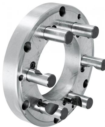
Der Bernardo Kurzkegelflansch FLD-200/D6 ist ein Kurzkegelflansch in Gussausführung. Er ist maschinenseitig fertig bearbeitet und futterseitig vorgedreht und gebohrt. Der Flansch ist für die Befestigung von Planspiral-Drehfutter und Planscheiben mit zylindrischer Aufnahme geeignet.
