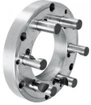
Der Bernardo Kurzkegelflansch FLD-200/D6 ist ein Kurzkegelflansch in Gussausführung. Er ist maschinenseitig fertig bearbeitet und futterseitig vorgedreht und gebohrt. Der Flansch ist für die Befestigung von Planspiral-Drehfutter und Planscheiben mit zylindrischer Aufnahme geeignet.
