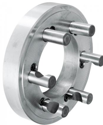
Der Bernardo Kurzkegelflansch FL-630/D11 ist ein Kurzkegelflansch in Gussausführung. Er ist maschinenseitig fertig bearbeitet und futterseitig plan gedreht. Der Flansch ist für die Befestigung von Planspiral-Drehfuttern und Planscheiben mit zylindrischer Aufnahme geeignet.
