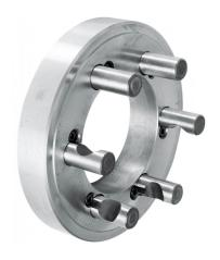
Der Bernardo Kurzkegelflansch FL-630/D8 ist ein Kurzkegelflansch mit einer Flanschgröße von 630/D8 und einem Durchmesser von 630 mm. Der Kegel hat eine Größe von 8. Die Maße betragen A = 635 mm, B = 42 mm und der Durchlass beträgt 136,2 mm.
