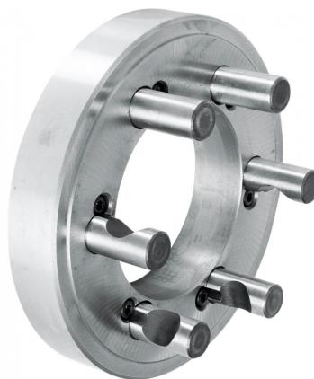
Der Bernardo Kurzkegelflansch FL-630/D8 ist ein Kurzkegelflansch in Gussausführung. Er ist maschinenseitig fertig bearbeitet und futterseitig plan gedreht. Der Flansch ist für die Befestigung von Planspiral-Drehfutter und Planscheiben mit zylindrischer Aufnahme geeignet.
