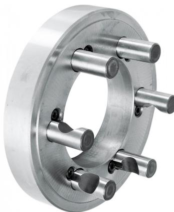
Der Bernardo Kurzkegelflansch FL-500/D8 ist ein Kurzkegelflansch in Gussausführung. Er ist maschinenseitig fertig bearbeitet und futterseitig plan gedreht. Der Flansch ist für die Befestigung von Planspiral-Drehfutter und Planscheiben mit zylindrischer Aufnahme geeignet.
