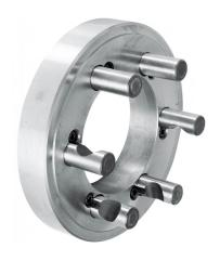
Der Bernardo Kurzkegelflansch FL-125/D4 ist ein Kurzkegelflansch in Gussausführung. Er ist maschinenseitig fertig bearbeitet und futterseitig plan gedreht. Der Flansch ist für die Befestigung von Planspiral-Drehfutter und Planscheiben mit zylindrischer Aufnahme geeignet.
