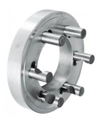
Der Bernardo Kurzkegelflansch FL-125/D3 ist ein Kurzkegelflansch in Gussausführung. Er ist maschinenseitig fertig bearbeitet und futterseitig plan gedreht. Der Flansch ist für die Befestigung von Planspiral-Drehfutter und Planscheiben mit zylindrischer Aufnahme geeignet.
