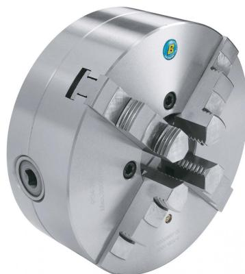
**Bernardo Präzisions-4-Backenfutter PO4-400/D8 4-Backenfutter aus Stahl** ist ein Präzisions-Vierbackendrehfutter mit Camlock-Direktbefestigung nach DIN 55029. Es ist geeignet für konventionelle Drehmaschinen und zum Spannen von rechteckigen und runden Werkstücken.
