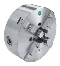
Das Bernardo Präzisions-4-Backenfutter PO4-315/D6 ist ein 4-Backenfutter aus Stahl mit einer Futtergröße von 315/D6 und einem Durchmesser von 315 mm. Es verfügt über einen Kegel von 6 und eine maximale Drehzahl von 2800 U/min. Das Gewicht beträgt etwa 51 kg.
