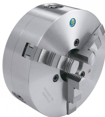
Das Bernardo Präzisions-3-Backenfutter PO3-250/D8 ist ein hochpräzises Dreibackendrehfutter aus Stahl für höhere Drehzahlen und längere Lebensdauer. Es ist mit Camlock-Direktaufnahme nach DIN 55029 ausgestattet und geeignet für konventionelle Drehmaschinen sowie Maschinen mit erhöhter Rundlaufgenauigkeit.
