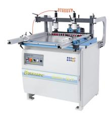
Die Universal-Dübellochbohrmaschine Multibor DB 21 ist mit 21 Bohrspindeln ausgestattet und eignet sich zur Herstellung von Korpus-, Rahmen-, Beschlag- und Reihenbohrungen. Das pneumatisch schwenkbare Bohraggregat gewährleistet kurze Umrüstzeiten, die Maschine ist dadurch universell einsetzbar und überzeugt durch ein gutes Preis-Leistungs-Verhältnis.
