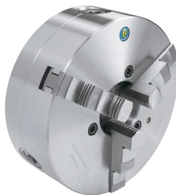
Das Bernardo Präzisions-3-Backenfutter PO3 - 400 ist ein hochpräzises Dreibackendrehfutter, das für Dreh- und Schleifmaschinen geeignet ist. Es verfügt über eine Zentrieraufnahme nach DIN 6350 und ist aus Stahl gefertigt, um höhere Drehzahlen und eine längere Lebensdauer zu ermöglichen.
