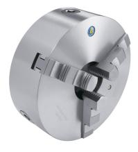
Das Bernardo Standard-3-Backenfutter PS3-400 ist ein 3-Backenfutter aus Guss. Es hat eine A-Futtergröße von 400, eine B-Abmessung von 105 mm, eine C-Abmessung von 5 mm, eine D-Abmessung von 330 mm, eine E-Abmessung von 136 mm, eine F-Abmessung von 362 mm, eine G-Abmessung von M16, eine H-Abmessung von 145 mm, eine J-Abmessung von 55 mm, eine maximale Drehzahl von 1000 U/min und wiegt ca. 85 kg.
