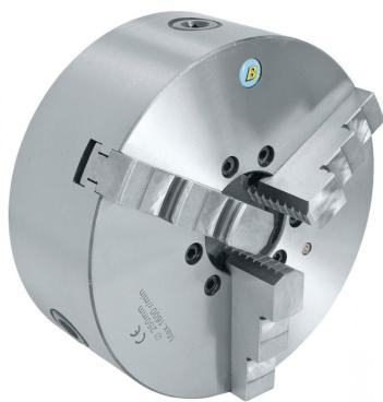
Das Bernardo Standard-3-Backenfutter DK11-315/D6 ist ein hochwertiges Dreibackendrehfutter aus Guss. Es verfügt über eine Camlock-Direktbefestigung nach DIN 55029 und ist geeignet für konventionelle Drehmaschinen.
