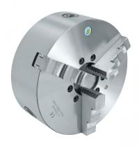
Das Bernardo Standard-3-Backenfutter DK11-315/D6 ist ein hochwertiges Dreibackendrehfutter aus Guss. Es verfügt über eine Camlock-Direktaufnahme nach DIN 55029 und ist geeignet für konventionelle Drehmaschinen.
