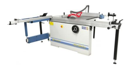
Die Formatkreissägen der FKS Pro-Serie sind je nach Anwendung wahlweise mit drei verschiedenen Tischlängen lieferbar (2600 / 2800 / 3200 mm). Serienmäßig ausgestattet mit einem 3,8 kW Motor und einem Sägeblatt mit 315 mm Durchmesser für Schnitthöhen bis 100 mm, sowie einem Vorritzaggregat für ein ausreißfreies Bearbeiten beschichteter Plattenwerkstoffe.
