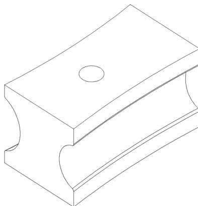
Der Bernardo Gleitschuh 1“ W (Ø25,4) x 1 1/4“ W (Ø31,8) ist für die Modelle BM 42 A und BM 60 A konzipiert. Dieser Gleitschuh ist speziell entwickelt, um eine optimale Leistung und Langlebigkeit zu gewährleisten.
