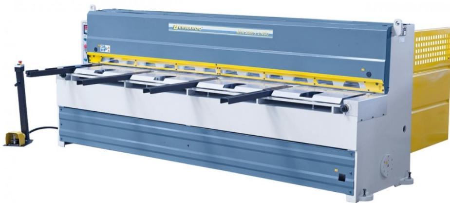
Die Bernardo MTA 3060 x 2 mm NCC Motorische Tafelscheren ist eine professionelle Schere für die Bearbeitung von Blechen. Sie ist serienmäßig mit einer Blechhochhaltevorrichtung ausgestattet, die optimal für Dünnbleche ist. Die Schere verfügt über Auflagearme an der Vorderseite für leichtes Bearbeiten großer Platten und einen motorischen Hinteranschlag, der präzises Verfahren über Kugelumlaufspindeln ermöglicht.
