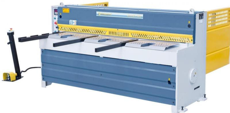
Die Bernardo MTA 2060 x 3 NCC Motorische Tafelscheren ist eine professionelle Scheranlage für die Bearbeitung von Blechen. Sie ist serienmäßig mit einer Blechhochhaltevorrichtung ausgestattet, optimal für Dünnbleche, und verfügt über Auflagearme an der Vorderseite für leichtes Bearbeiten großer Platten. Der motorische Hinteranschlag ermöglicht präzises Verfahren über Kugelumlaufspindeln.
