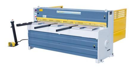
Die Bernardo MTA 2060 x 3 NCC Motorische Tafelscheren ist eine leistungsstarke Maschine für die Metallbearbeitung. Mit einer Schnittlänge von 2060 mm und einer Max. Blechstärke von 3 mm ist sie ideal für verschiedene Anwendungen. Die Maschine verfügt über eine Arbeitshöhe von 810 mm und einen Hinteranschlag von 0 - 750 mm.
