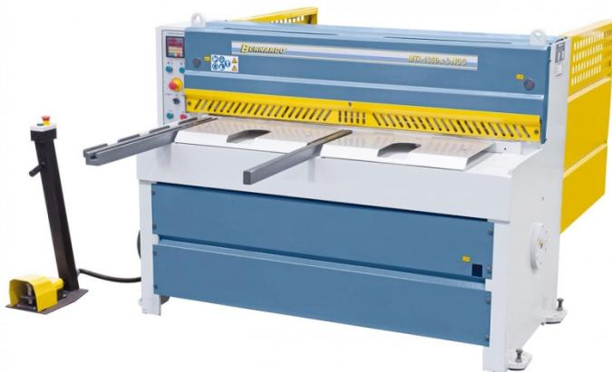
Die Bernardo MTA 1360 x 3 NCC Motorische Tafelscheren ist eine professionelle Maschine für das Schneiden von Blechen. Sie ist serienmäßig mit einer Blechhochhaltevorrichtung ausgestattet, optimal für Dünnbleche. Die Maschine verfügt über Auflagearme an der Vorderseite für leichtes Bearbeiten großer Platten und einen motorischen Hinteranschlag, der präzises Verfahren über Kugelumlaufspindeln ermöglicht.
