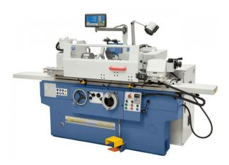
Die Universal-Rundschleifmaschine URS 800 N lässt bereits in der Standardausführung (Innenschleifeinrichtung, 2-Achs-Positionsanzeige, usw.) keine Wünsche offen. Aufgrund Ihrer Konzeption eignet sich diese Maschine hervorragend für den Einsatz im Formen- und Werkzeugbau, dieses Modell wird aber auch bei kleineren Serien in der Produktion eingesetzt.
