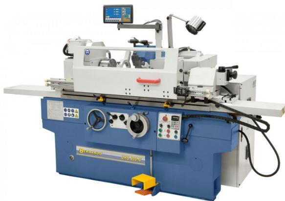
Die Universal-Rundschleifmaschine URS 800 N eignet sich hervorragend für den Einsatz im Formen- und Werkzeugbau sowie bei kleineren Serien in der Produktion. Die Maschine verfügt über eine Innenschleifeinrichtung, 2-Achs-Positionsanzeige und weitere Funktionen, die sie zu einer vielseitigen und leistungsfähigen Maschine machen.
