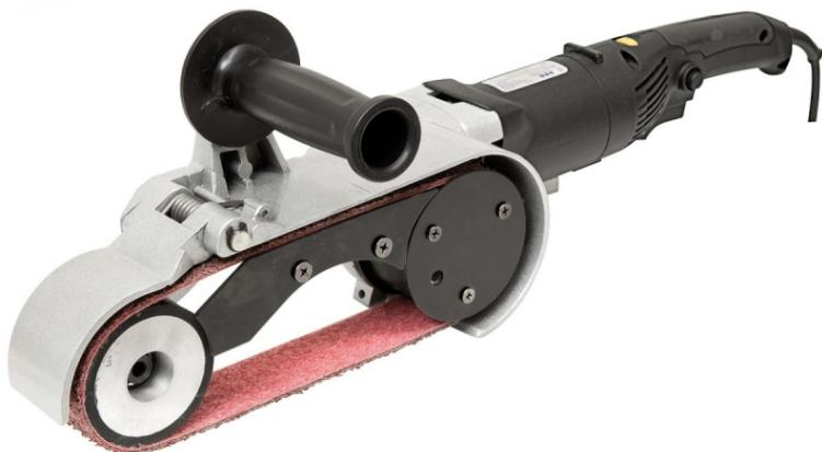
Die Bernardo TBS 620 Rohrschleifmaschinen sind ideal für das Verschleifen von Schweißnähten auf Rohren. Durch den beweglichen Schwenkarm passt sich das Schleifband dem jeweiligen Rohrdurchmesser an. Die große Kontaktrolle ermöglicht ein Verschleifen von Schweißnähten auf planen Flächen ohne Verkanten oder Wellenbildung. Ergonomische Zweihandbedienung für ermüdfreies Arbeiten.
