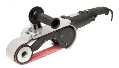
Die Bernardo TBS 620 Rohrschleifmaschinen sind ideal für das Verschleifen von Schweißnähten auf Rohren. Durch den bewedlichen Schwenkarm passt sich das Schleifband dem jeweiligen Rohrdurchmesser an. Die große Kontaktrolle ermöglicht ein Verschleifen von Schweißnähten auf planen Flächen ohne Verkanten oder Wellenbildung. Ergonomische Zweihandbedienung für ermüdungsfreies Arbeiten.
