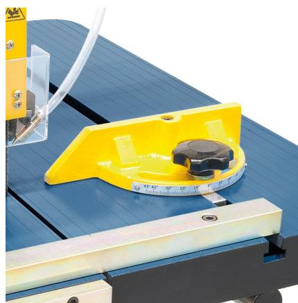
Der Gehrungsanschlag für die VMS-Serie ist ein Zubehörteil, das speziell für die Sägemaschinen dieser Serie entwickelt wurde. Er ermöglicht eine präzise und sichere Bearbeitung von Holz und anderen Materialien.
