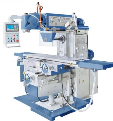
Das Modell UWF 150 Servo ist eine sehr stabil gebaute Universalfräsmaschine mit verschiebbarem Oberarm und großer Tischaufspannfläche. Die großdimensionierten Führungen in allen Achsen garantieren auch bei hoher Tischbelastung ein Höchstmaß an Stabilität und Präzision. Besondere Merkmale dieser Maschine sind der schwenkbare Arbeitstisch, die Flachführung in y- und z-Achse und der Servoantrieb für Vorschübe und Eilgang in allen Achsen.
