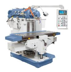
Die Universalfräsmaschine Variomill FU 1600 E Servo überzeugt durch die massive und schwere Graugusskonstruktion, wodurch diese Maschine für eine schwere Zerspanung bei großen Werkstücken optimal geeignet ist. Hauptmerkmale dieser Maschine sind der Servoantrieb in allen Achsen, der großzügig dimensionierte Arbeitstisch sowie die großen Verfahrwege.
