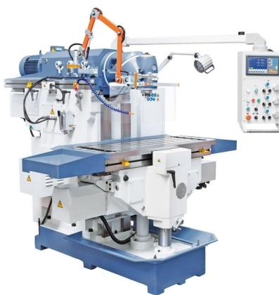
Die Universalfräsmaschine Variomill FU 1200 E Servo überzeugt durch die massive und schwere Graugusskonstruktion, wodurch diese Maschine für eine schwere Zerspanung bei großen Werkstücken optimal geeignet sind. Hauptmerkmale dieser Maschine ist der Servoantrieb in allen Achsen, der großzügig dimensionierte Arbeitstisch sowie die großen Verfahrwege.
