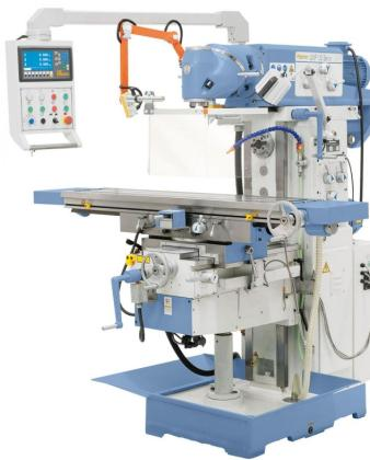
Die Universalfräsmaschine UWF 130 Servo mit verschiebbarem Oberarm ist eine Weiterentwicklung der bekannten UWF 130. Durch den auf sämtliche Winkelpositionen einstellbaren Fräskopf und einem Verfahrweg von 1000 mm in der x-Achse ist diese Maschine vielseitig einsetzbar. Besonderes Merkmal dieses Models ist der Eilgang und die 8 Vorschübe in allen Achsen, angetrieben über einen Servomotor.
