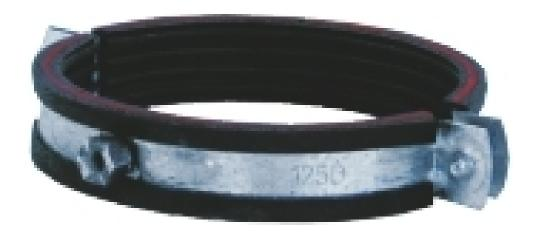
Die Rohrmontageschelle ist für Rohrdurchmesser 160 mm passend. Sie verfügt über eine geräuschdämmende Einlage und ist mit Innengewinde M8 und M10 zum Einschrauben von Stockschrauben oder Gewindestangen ausgestattet. Häufige Verwendung findet die Rohrmontageschelle zur Rohrmontage im Abstand von ca. 1,5 Meter und vor und nach Bögen und Schiebern.
