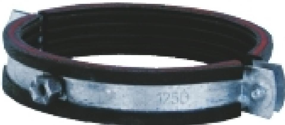
Die Rohrmontageschelle ist für Rohrdurchmesser 160 mm passend. Sie verfügt über eine geräuschdämmende Einlage und ist mit Innengewinde M8 und M10 zum Einschrauben von Stockschauben oder Gewindestangen ausgestattet. Häufige Verwendung findet die Rohrmontageschelle zur Rohrmontage im Abstand von ca. 1,5 Meter und vor und nach Bögen und Schiebern.
