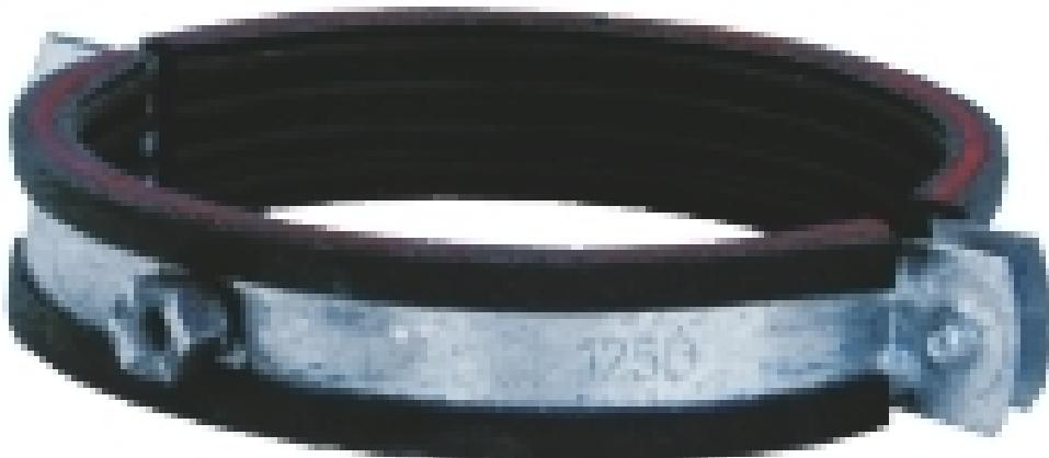
Die Rohrmontageschelle ist für Rohrdurchmesser 125 mm passend und verfügt über eine geräuschkämmende Einlage. Sie ist mit Innengewinde M8 und M10 zum Einschrauben von Stockschauben oder Gewindestangen ausgestattet. Häufige Verwendung findet sie zur Rohrmontage im Abstand von ca. 1,5 Meter und vor und nach Bögen und Schiebern.
