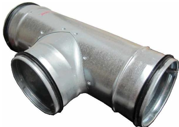
Der Abzweiger 125 / 90 Grad ist für Rohrdurchmesser von 125 mm passend. Er verfügt über eine integrierte Dichtung. Es ist jedoch zu beachten, dass der Materialfluss nicht optimal ist, weshalb der Abzweiger mit 45 Grad empfohlen wird. Häufig wird dieser Abzweiger in Verbindung mit dem Verbindungsstück Muffe verwendet.
