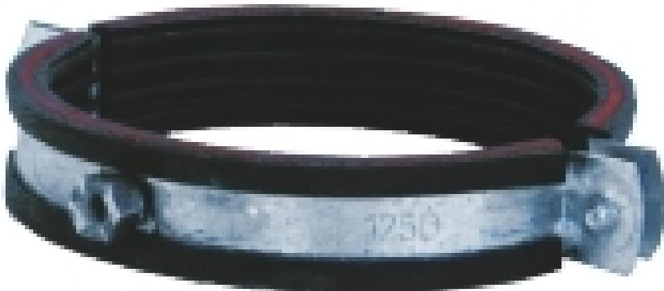
Die Montageschelle 100 ist für Rohrdurchmesser 100 mm passend und verfügt über eine geräuschdämmende Einlage. Sie ist mit Innengewinde M8 und M10 zum Einschrauben von Stockschauben oder Gewindestangen ausgestattet. Häufige Verwendung findet diese Schelle zur Rohrmontage im Abstand von ca. 1,5 Meter und vor und nach Bögen und Schiebern.
