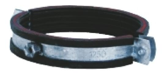
Die Montageschelle 100 ist für Rohrdurchmesser 100 mm passend und verfügt über eine geräuschdämmende Einlage. Sie ist mit Innengewinde M8 und M10 zum Einschrauben von Stockschrauben oder Gewindestangen ausgestattet. Häufige Verwendung findet diese Schelle zur Rohrmontage im Abstand von ca. 1,5 Meter und vor und nach Bögen und Schiebern.
