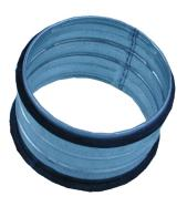
für Rohrdurchmesser 100 mm passend Nippel mit integrierter Dichtung Häufige Verwendung zum Verbinden von 2 Rohren! Das preisgünstige Rohrsystem mit einfacher Montage! Die Absaugteile sind in verzinktem Blech mit 0,55 mm Stärke gefertigt. Die Verbindungsstücke mit integrierten Dichtungsringen garantieren eine einfache Montage. Das gesamte System ist in 3 Dimensionen lagernd 100/125 und 160 mm
