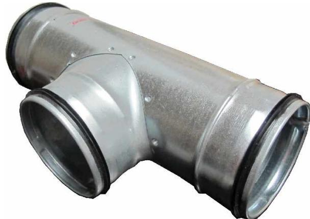
Der Abzweiger 100 / 90 Grad ist für Rohrdurchmesser von 100 mm passend. Er verfügt über eine integrierte Dichtung. Es ist jedoch zu beachten, dass der Materialfluss nicht optimal ist, weshalb der Abzweiger mit 45 Grad empfohlen wird. Häufig wird dieser Abzweiger in Verbindung mit dem Verbindungsstück Muffe verwendet.
