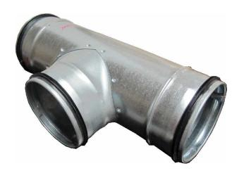
Der Abzweiger 100 / 90 Grad ist für Rohrdurchmesser von 100 mm passend. Er verfügt über eine integrierte Dichtung. Es ist jedoch zu beachten, dass der Materialfluss nicht optimal ist, weshalb der Abzweiger mit 45 Grad empfohlen wird. Häufig wird dieser Abzweiger in Verbindung mit dem Verbindungsstück Muffe verwendet.
