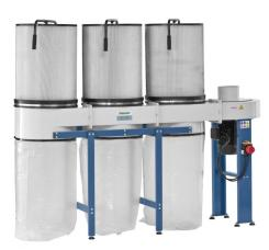
Das Modell DC 650 CF ist durch die in der Grundausstattung enthaltenen Feinstaub-Filterpatronen noch leistungsfähiger (größere Filterfläche), dadurch filtern sie die Luft so effektiv, dass auch der gesundheitsschädliche Feinstaub in der Werkstatt auf ein Minimum reduziert wird.
