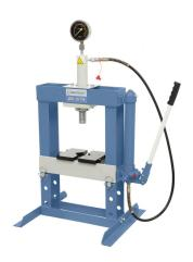
Die Bernardo WK 10 TH Werkstattpressen ist eine leistungsstarke Presse für verschiedene Anwendungen. Die Presse verfügt über eine Druckkraft von 10 t und einen Kolbenhub von 180 mm. Der Tisch bietet eine Breite von 140 mm und einen Durchgang von 330 mm. Die Presse ist auch mit einer verschiebbaren Zylinderanordnung ausgestattet, die eine flexible Verwendung ermöglicht.
