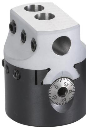
Der Bernardo Plan- und Ausdrehkopf diam. 50 mm ist ein hochpräzises Werkzeug für die Bearbeitung von Werkstücken. Der Kopfdurchmesser beträgt 50 mm, der Bohrstangendurchmesser 12 mm. Die Feinverstellung ermöglicht eine Genauigkeit von 0,01 mm pro Teilstrich.
