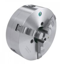
Das Bernardo Präzisions-3-Backenfutter PO3-400/D8 ist ein 3-Backenfutter aus Stahl mit einer Futtergröße von 400/D8. Es hat einen Durchmesser von 400 mm und einen Kegel von 8. Die Abmessungen betragen: B 108 mm, D 139,734 mm, E 136 mm und F1 171,4 mm. Das Futter verfügt über 6 Camlockbolzen und eine maximale Drehzahl von 2000 U/min. Das Gewicht beträgt etwa 101 kg.
