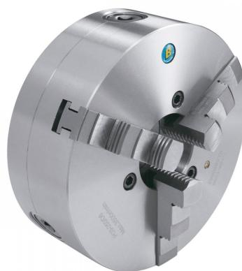
Das Bernardo Präzisions-3-Backenfutter PO3-125/D3 ist ein hochpräzises Dreibackendrehfutter aus Stahl für höhere Drehzahlen und längere Lebensdauer. Es ist mit Camlock-Direktaufnahme nach DIN 55029 ausgestattet und geeignet für konventionelle Drehmaschinen sowie für Maschinen mit erhöhter Rundlaufgenauigkeit.
