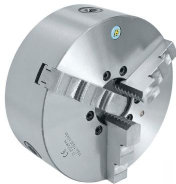
**Bernardo Standard-3-Backenfutter DK11-200/D6 3-Backenfutter aus Guss** ist ein hochwertiges Dreibackendrehfutter mit Camlock-Direktaufnahme nach DIN 55029. Es ist geeignet für konventionelle Drehmaschinen und wird inklusive je 1 Satz Dreh- und Bohrbacken geliefert.
