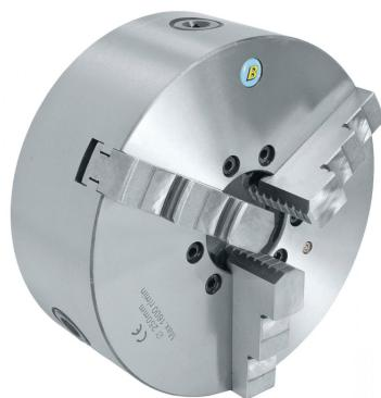
Das Bernardo Standard-3-Backenfutter DK11-200/D5 ist ein hochwertiges Dreibackendrehfutter aus Guss. Es ist mit Camlock-Direktaufnahme nach DIN 55029 ausgestattet und geeignet für konventionelle Drehmaschinen.
