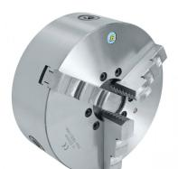
Das Bernardo Standard-3-Backenfutter DK11-200/D5 ist ein hochwertiges Dreibackendrehfutter aus Guss. Es ist mit Camlock-Direktaufnahme nach DIN 55029 ausgestattet und geeignet für konventionelle Drehmaschinen.
