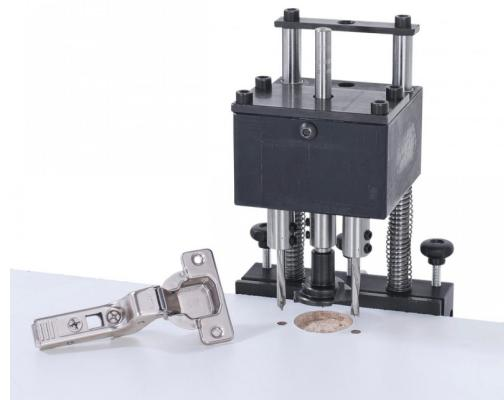
Die Bohrmaske für Scharniere Typ Blum bzw. Typ Grass hat drei Spindeln und ist dazu geeignet, die drei Löcher für die Befestigung von Scharnieren gleichzeitig auszuführen.
