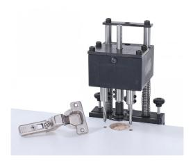
Die Bohrmaske für Scharniere Typ Blum bzw. Typ Grass hat drei Spindeln und ist dazu geeignet, die drei Löcher für die Befestigung von Scharnieren gleichzeitig auszuführen.
